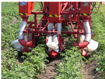
Controlul gândacului din Colorado prin adunare mecanică cu echipamentul ECG (produs de INMA București)
